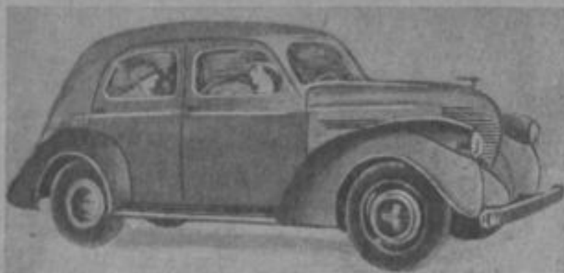
Рис. 6. Автомобиль Уиллис. Капот и решетка радиатора откидываются на петлях, установленных возле ветрового стекла. Горизонтальные рейки решетки и капота объединены
